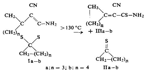
Die relativ unbeständigen, monomeren, tiefroten und unangenehm riechenden Thioketone werden abdestilliert, wobei sie sofort in hoher Reinheit mit 70–90-proz. Ausbeute anfallen. Das bei 56 °C/11 Torr siedende Cyclopentanthion (IIa) wird aus Ia (Fp 105–107 °C) bei 130 °C, das bei 74 °C/11 Torr destillierende Cyclohexanthion (IIb) aus Ib (Fp 118 °C) bei 135 °C erhalten.
