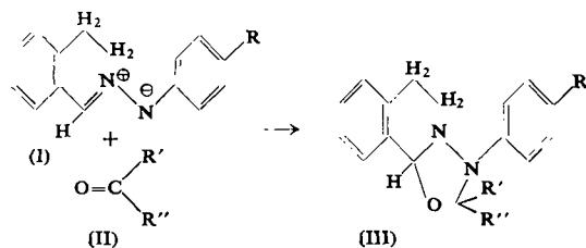
Zweckmäßig erzeugt man I in situ durch Dissoziation der Hexahydro-tetrazine IV bei 50–80 °C. Die Umsetzung gelingt mit aliphatischen, aromatischen und heterocyclischen Aldehyden; unter den Ketonen reagierte Mesoxalester.
